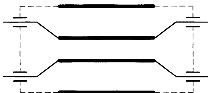
图 4c 对称和非对称使用的多单元穿心电容器(非同轴式)
